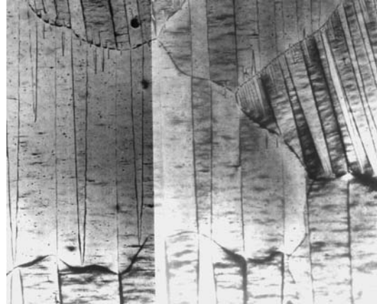
Figure 5.5 – Observation de domaines magnétiques à la surface d'une tôle GO, d'après [Hug, 1995]
